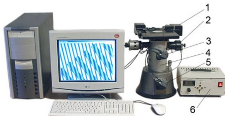
Рис. 1. Автоматизированный интерференционный микроскоп. 1 – автоматизированный двухкоординатный предметный стол; 2 – опорное зеркало на пьезоэлементе; 3,5 – ПЗС-камеры; 4 – микроинтерферометр; 6 – лазерный осветитель.
